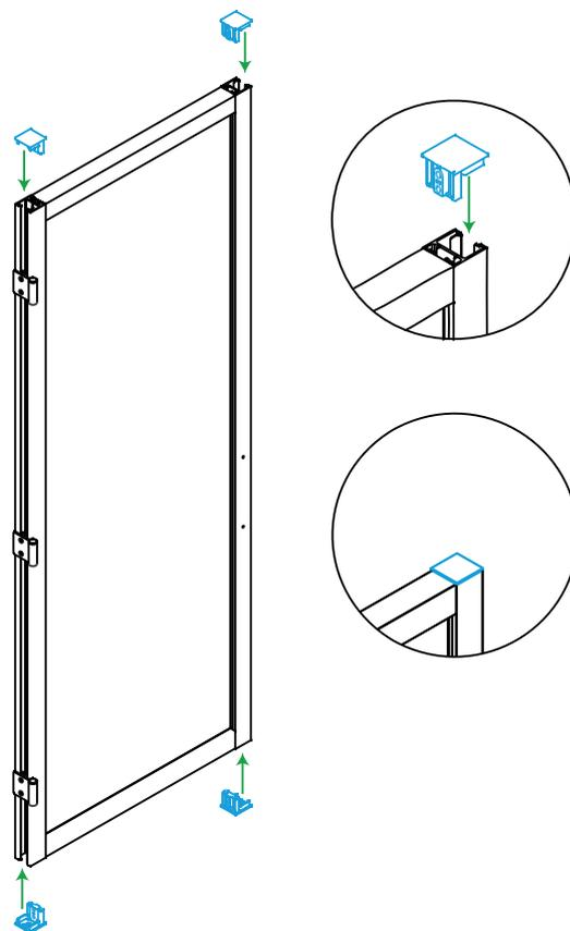
3 - Mise en place des capots d'assemblage porte 40 et 66
